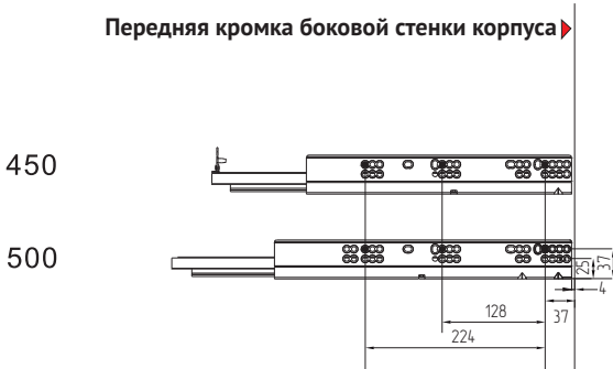
Схема присадки направляющих для стандартного ящика
